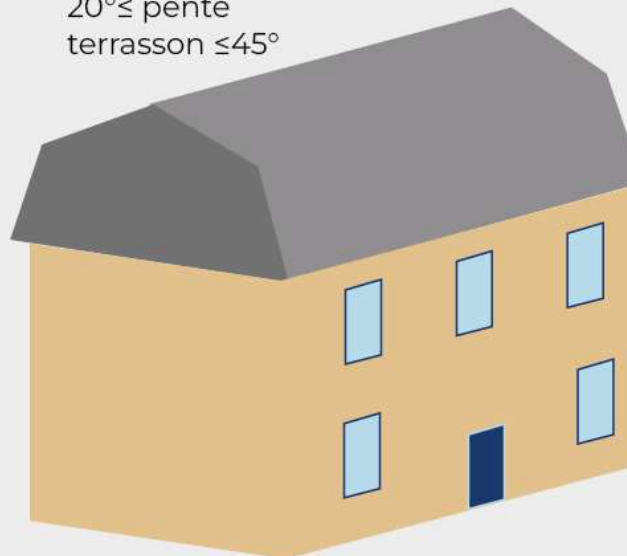
Toiture à la mansarde
